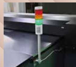
印刷時: 緑色、待機時: 黄色、エラー時: 赤色に点灯
